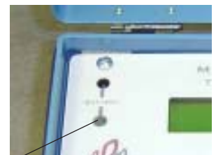
Témoin de charge de la batterie
